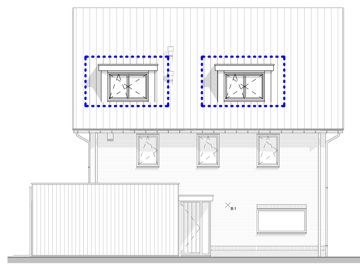
Linkergevel 1:100 - optie dakkapel zijgevel (vergunningsplichtig)
